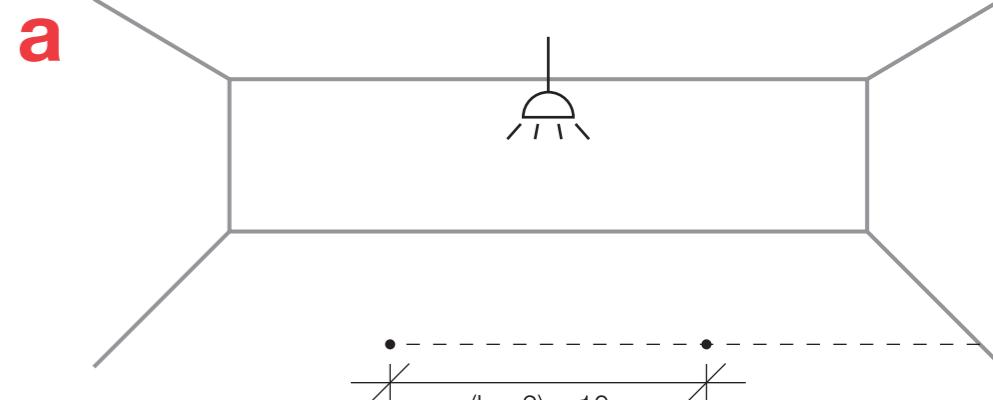
Marquer sur le sol, l'emplacement nécessaire à la pose du FUTURA en respectant les mesures de la Réserve correspondante à la dimension de la porte, "Lpx2" + 10 mm.
