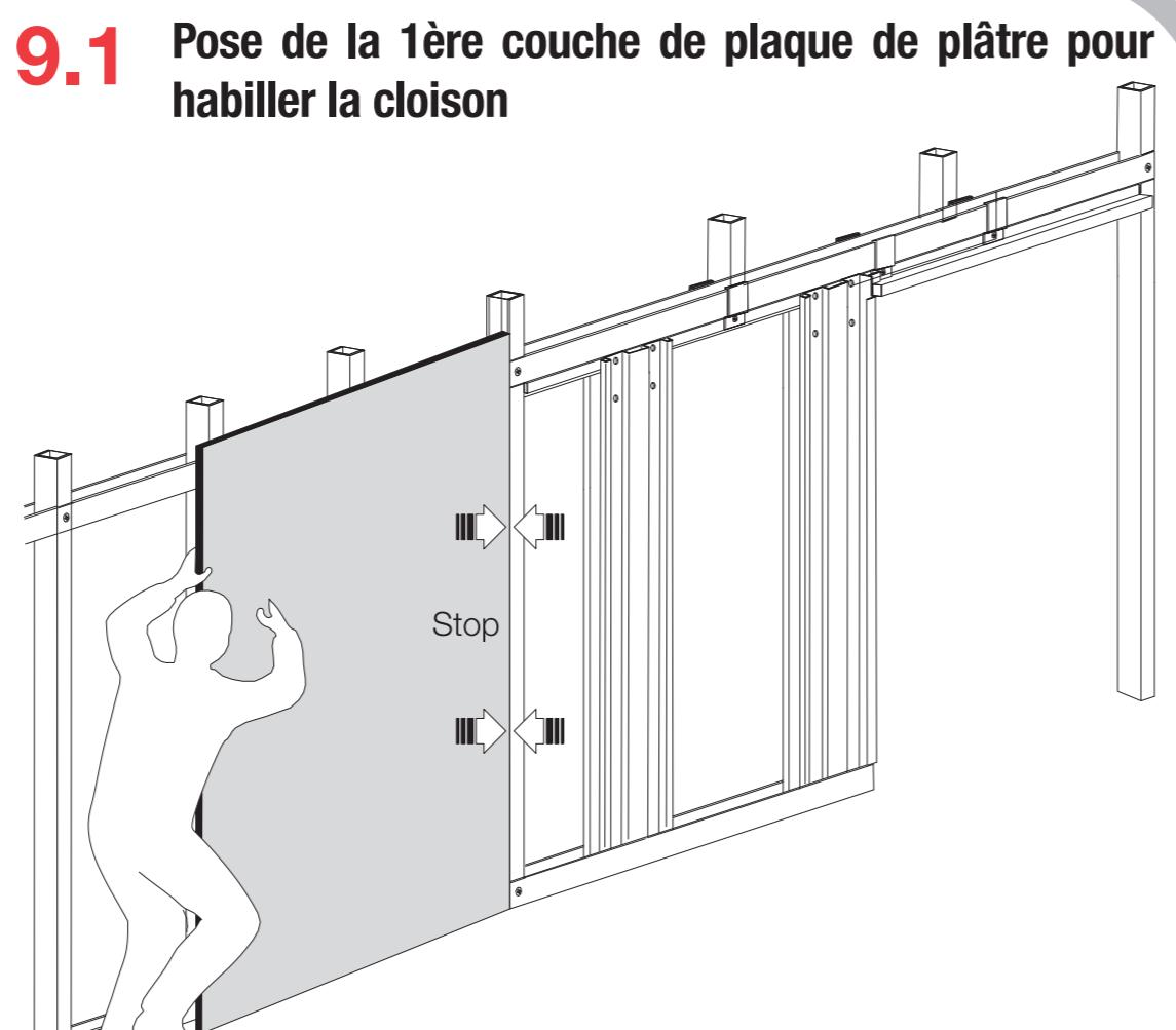
9.1- Positionner et fixer une première strate de plaques de plâtre (type BA13) sur la structure de la cloison. S'arrêter au montant métallique qui délimite la pose du FUTURA comme sur le schéma ci-dessus.
