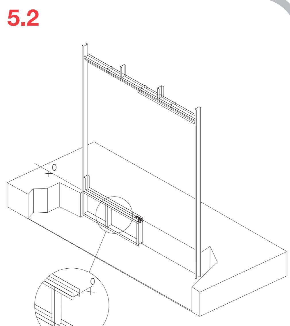
5.2- Dans le cas d'un sol non encore terminé, positionner l'embase A3 au niveau du sol fini (faire un calage s'il manque la chape de ciment et/ou le revêtement final).
