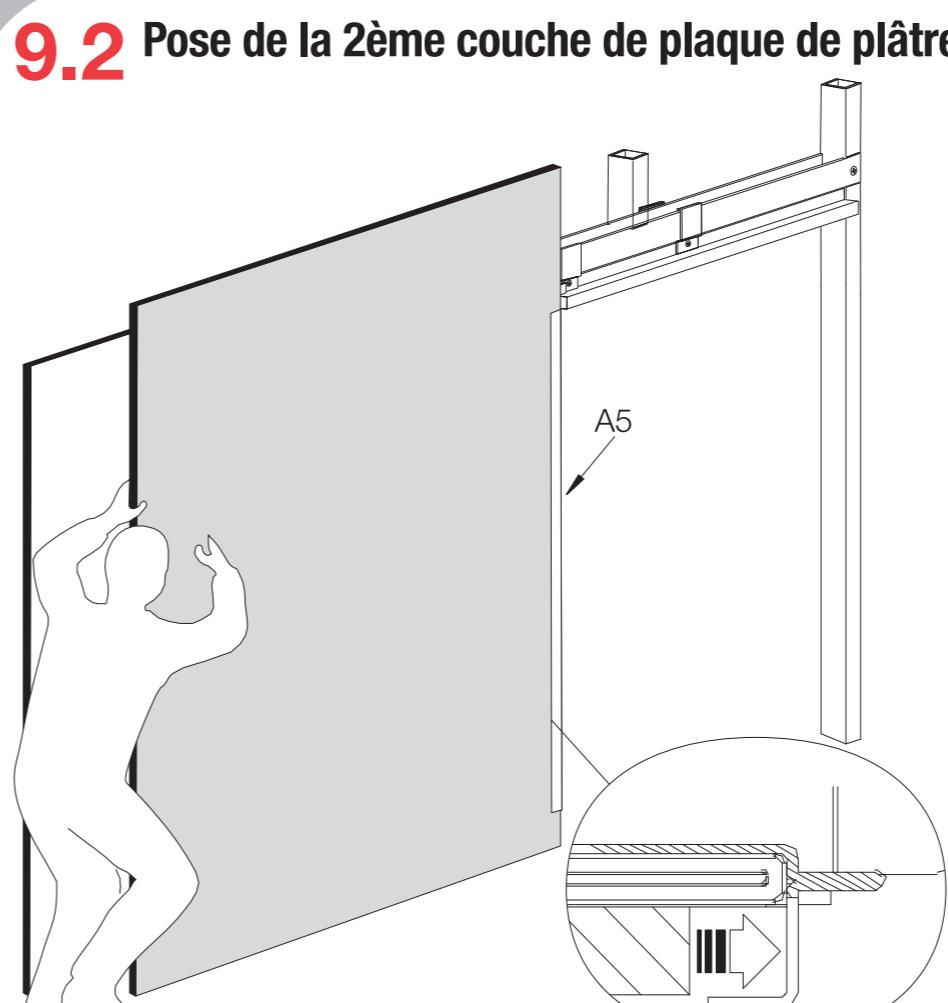
9.2- Positionner une plaque de plâtre (type BA13) sur la structure du FUTURA en la faisant glisser au fond du retour métallique A5 prévu pour maintenir la plaque de plâtre (voir schéma ci-dessus).
