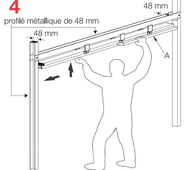
4- Cliper la traverse en bois sur le profilé métallique horizontal, grâce aux pinces métalliques préfixées sur les cotés de la traverse en bois et vérifier le niveau.
