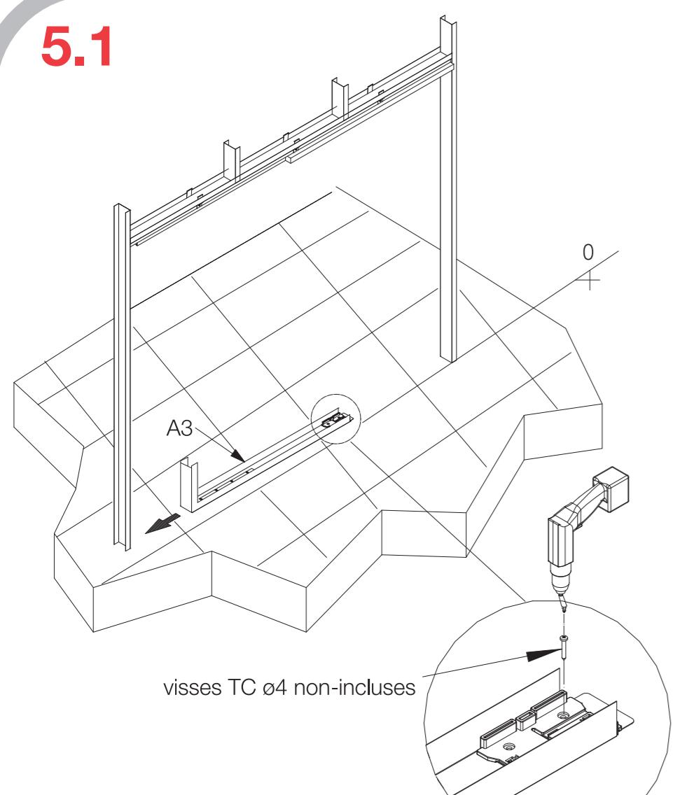
5.1- En cas de pose sur sol fini, fixer l'embase A3 contre le profilé métallique et fixer le au sol.
