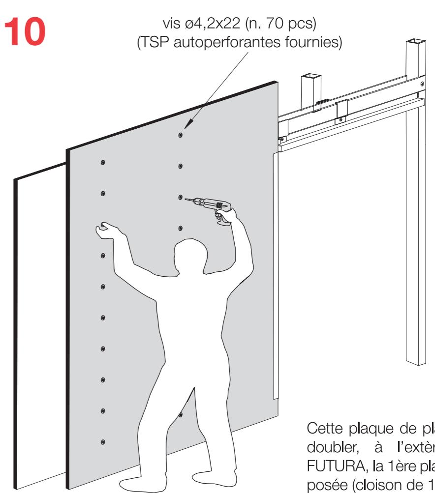
10- Fixer la plaque de plâtre (type BA13) dans les profilés métalliques A4 et A5 à l'aide des vis autoperforantes fournies.
