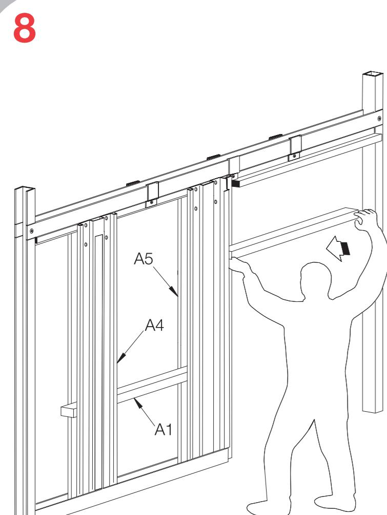
8- Se servir du polystyrène pour rigidifier l'ensemble avant de fixer les plaques de plâtre.
