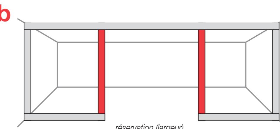
Construire la cloison en profilé métallique standard de 48 mm, en respectant la mesure de la Réserve correspondante à la dimension de la porte (voir tableau dans la rubrique "ORDRE DE TRAVAIL", colonne "Réserve dans la cloison").
