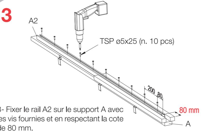
3- Fixer le rail A2 sur le support A avec les vis fournies et en respectant la cote de 80 mm.
