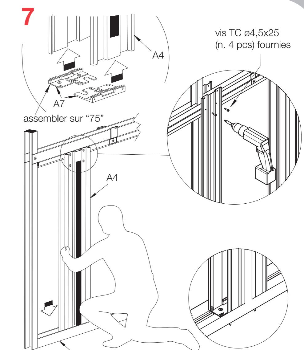
7- Positionner le 2ème sabot plastique noir, inclus dans le sachet d'accessoires, tout d'abord assembler les 2 parties plastiques qui le composent en choisissant la mesure "75". Positionner le sabot plastique noir dans l'embase A3 en le centrant entre le profilé métallique de la cloison et le profilé A5.
